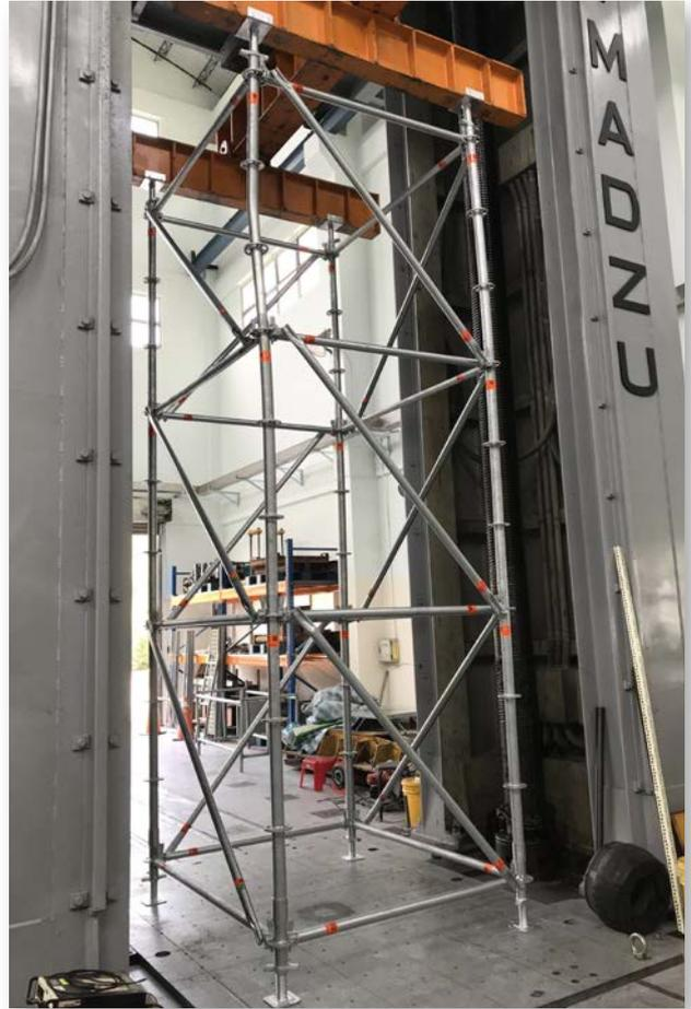
依據定期製作支撐架及其構件之抗壓測試，確實掌握本公司各項產品的穩定性，作為工程規劃設計參考。
